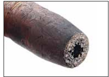
Buse complètement bouchée (n'utilisant pas le E-WELD Nozzle)
