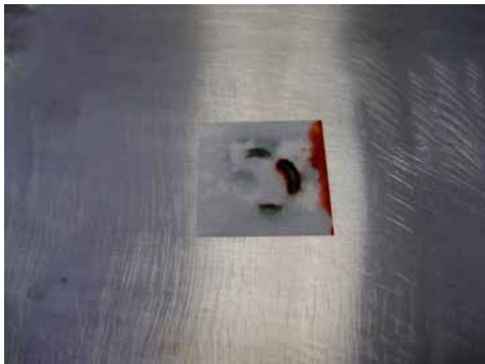
La coloration rouge du papier de test après le test indique la présence du type 316. La surface doit être nettoyée après le test puisque des dépôts peuvent être laissés derrière.
