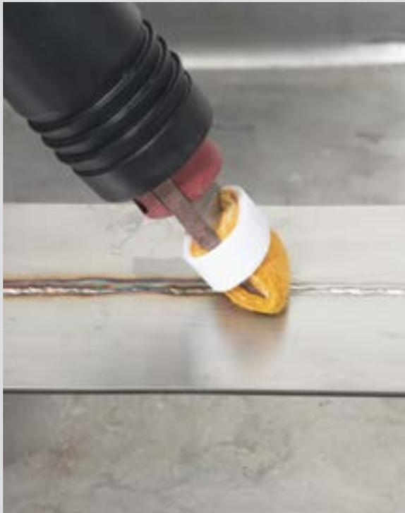
La pasivación sucede cuando el cromo presente en el acero inoxidable entra en contacto con el oxígeno en el aire. Esta reacción química forma una capa pasiva de óxido de cromo, la cuál protege la superficie de acero inoxidable. Para formar una capa gruesa y uniforme de óxido de cromo, la superficie debe estar completamente limpia y libre de cualquier contaminante.
