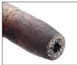
Buse complètement bouchée (n'utilisant pas le E-WELD Nozzle)
