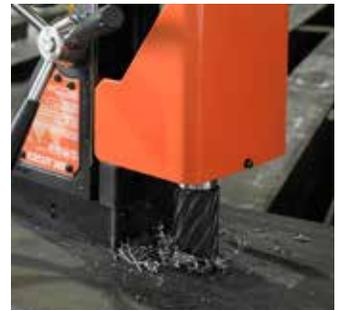
Pour un plus grand trou, 1/2" et plus, utilisez la base magnétique avec une tige Weldon standard
